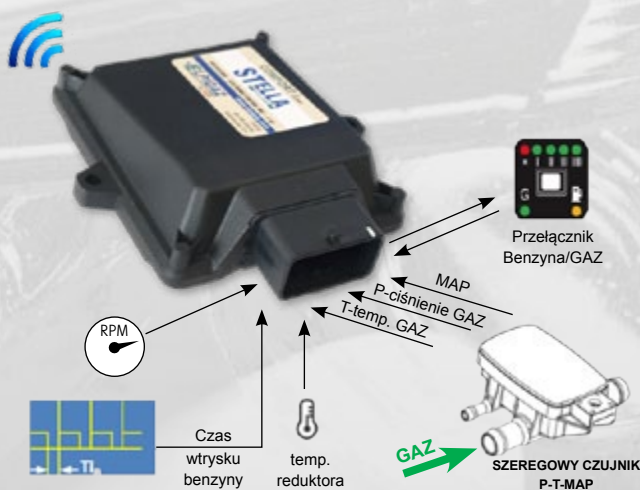
SCHEMAT POŁĄCZEŃ STEROWNIKA POLARE
